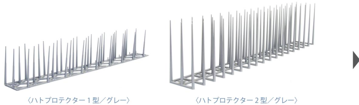
ポリプロピレン製のハトプロテクターは、下地に直接接着やビス打ちするのが難しいので、基本的にベースに専用止め具を装着して使用します。
