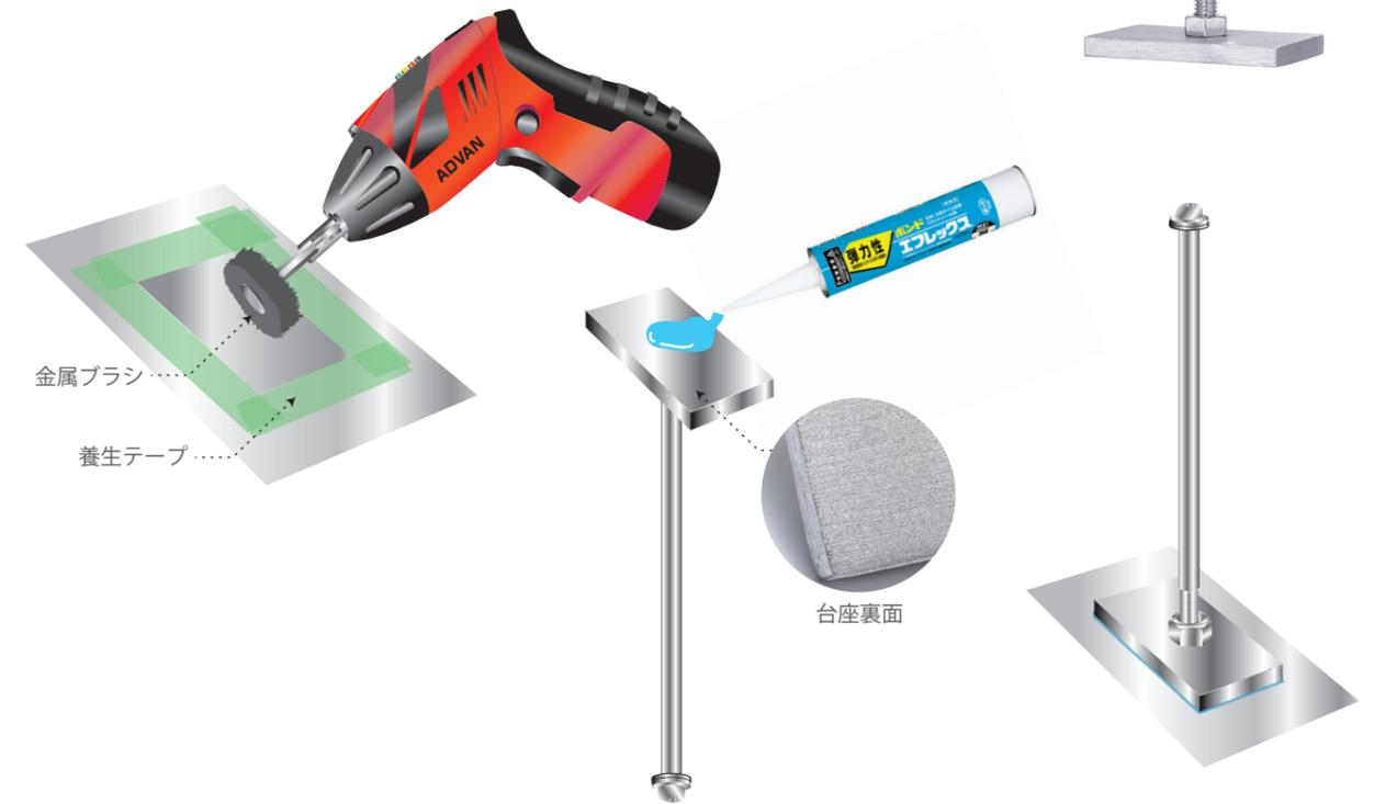
下地台座の面積(30×50)を削り、目荒しする。養生テープを使用
