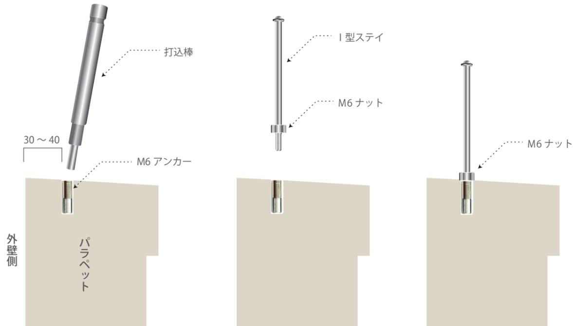
あけた下穴にM6のアンカーを入れ、アンカー打込棒で固定する
